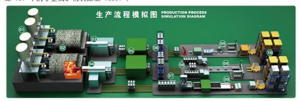
公司主要从事玻璃纤维及制品的生产、销售。玻璃纤维是一种新型无机非金属材料,以叶腊石、高岭土、石灰石、石英砂等矿石为原料(上图 01 各种矿石按照比例配制)经高温熔制(上图 02)、拉丝(上图 03 和 04)、烘干(上图 05 和 06)、络纱(上图 07)等工艺制造而成,其单丝直径为几微米到二十几微米,相当于一根头发丝的 1/20 至 1/5,每束纤维原丝都由数百根甚至上千根单丝组成。根据玻璃中的碱含量的多少,可分为无碱玻璃纤维、中碱玻璃纤维和高碱玻璃纤维,其中无碱玻璃纤维占据全行业 95%以上的产量规模。玻璃纤维具有轻质、高强、耐腐蚀、电绝缘、隔热等优异性能,作为国家战略性新材料产业的重要组成部分,产品广泛应用于交通运输(汽车及交通工具轻量化)、可再生能源(风电)、 电子通讯(PCB 应用)、节能环保、建筑材料等领域。下游领域中有成长性较好的应用领域(汽车轻量化、风电、5G),也有偏周期的应用领域(基建、建筑、管罐等),在国民经济中发挥着越来越重要的作用。
